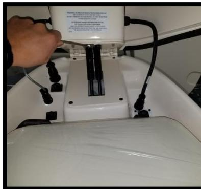
Figure 7.1.2 Removing Flange Bolt.
